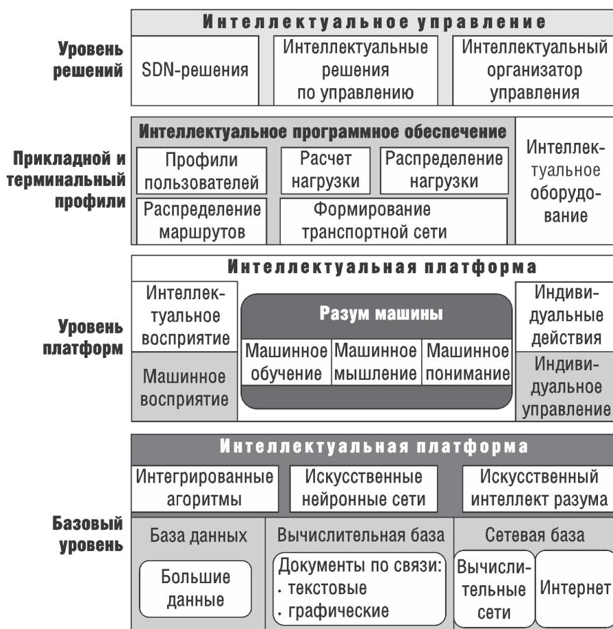
Рис. 2. Архитектура формирования системы связи на основе интеллектуальной плоскости
