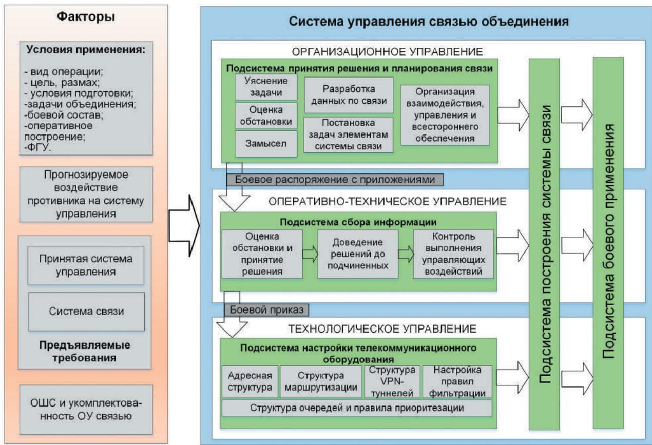
Рис.2. Модель системы управления связью объединения
