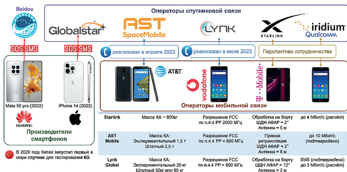
Рис. 6. Перспективная тенденция по созданию низкоорбитальных систем связи со смартфонами D2D
