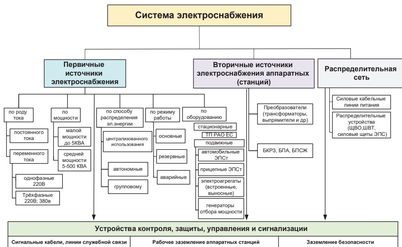
Рис. 1. Функциональные элементы системы электроснабжения специального назначения
