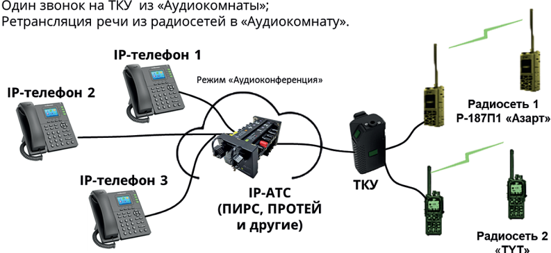
Рис. 11. Вариант применения ТКУ «Метафора» для обеспечения связи при взаимодействии телефонных и радиосетей
