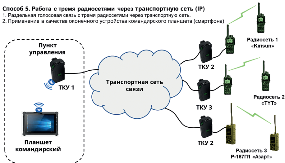
Рис. 9. Варианты подключения ТКУ «Метафора» для работы в трех радиосетях через транспортную сеть
