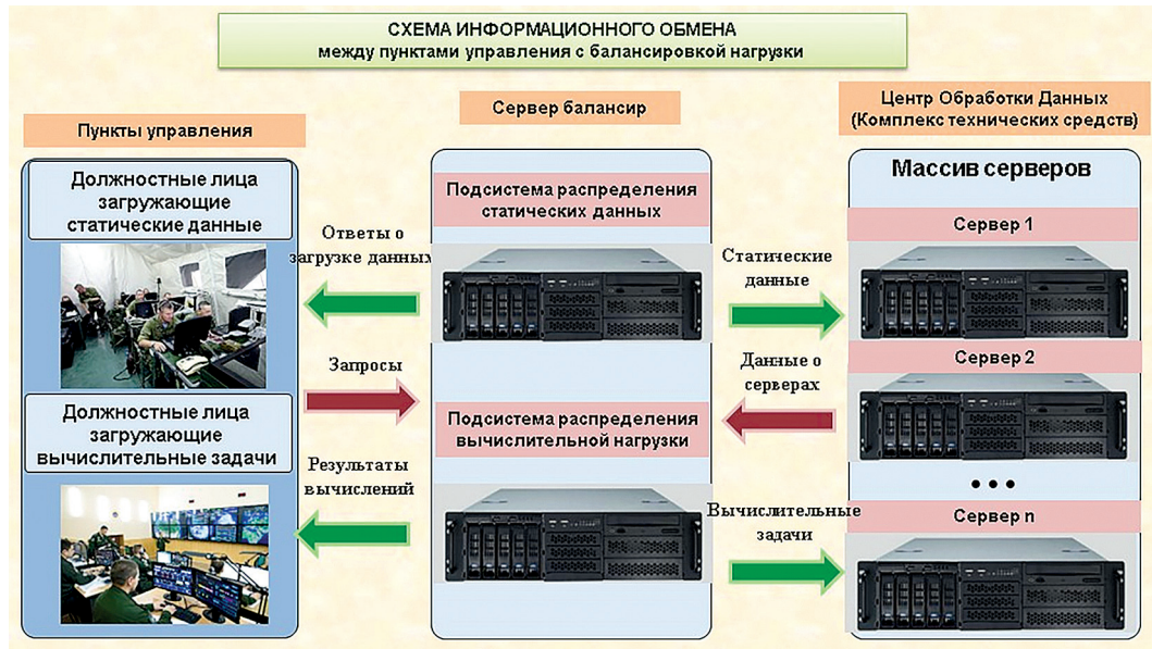
Рис. 1. Схема информационного обмена между пунктами управления с балансировкой нагрузки
