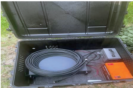
Рис. 5. Вариант состава и размещения мобильного комплекса ретрансляции с ТКУ
