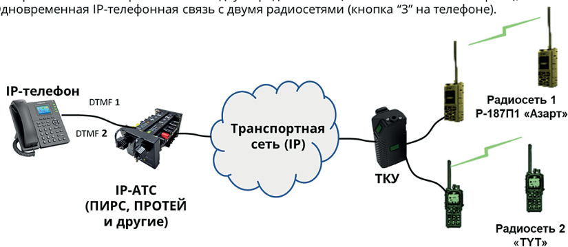
Рис. 10. Вариант применения ТКУ «Метафора» совместно с IP АТС
