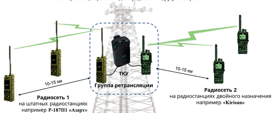
Рис. 4. Вариант размещения ТКУ на вышке для ретрансляции и сопряжения радиосетей
