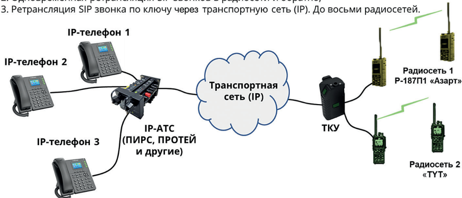
Рис. 12. Вариант применения ТКУ «Метафора» для обеспечения групповой работы
