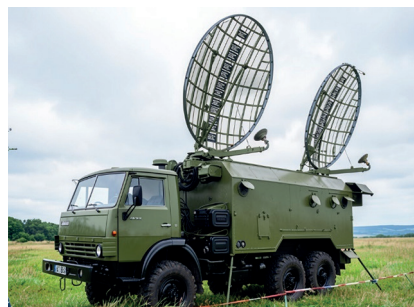
Тропосферная станция Р-423-2А
