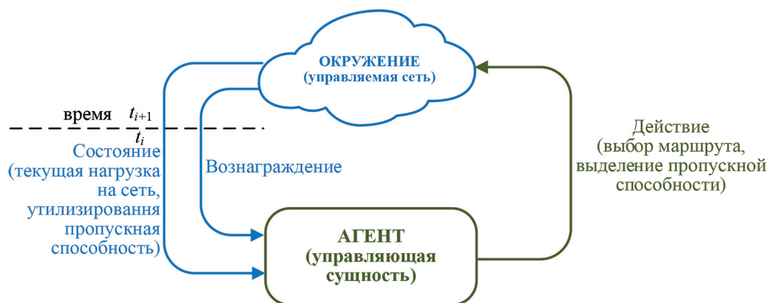
Рис. 6. Схема взаимодействия агента и окружения в парадигме обучения с подкреплением
