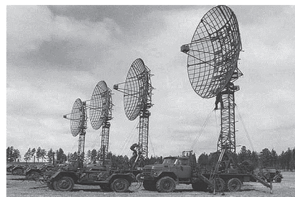
Тропосферная станция Р-410 (шифр «Атлет»)
