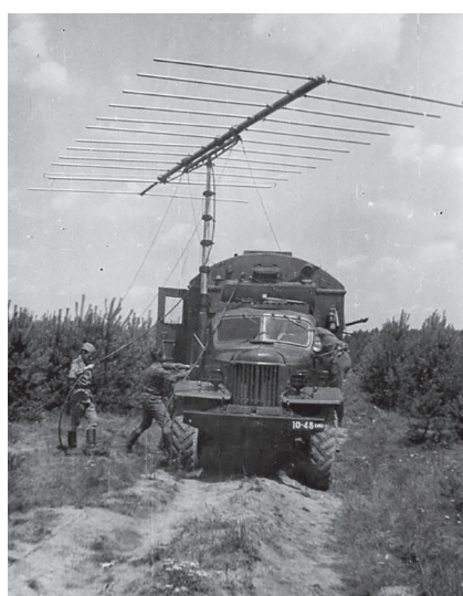
Тропосферная радиорелейная станция Р-121 (шифр «Фрегат»)
