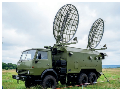
Тропосферная станция Р-423-2А
