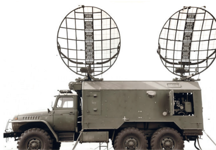
Тропосферная станция Р-423-1
