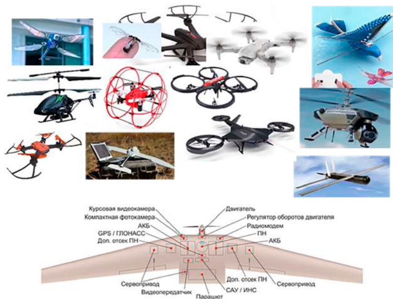
Рис. 3. Схемы построения нано- и микро-БЛА РФН с указанием размещения бортового оборудования
