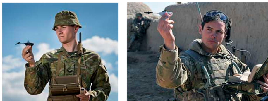
Рис. 2. Нано-БЛА вертолётного типа PD-100 Black Hornet Nano
